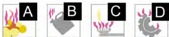
Sl. 54. Požar klase «A» je požar zapaljivih krutih tvari. Požar klase «B» je požar zapaljivih tekućina. Požar klase «C» je požar zapaljivih plinova. Požar klase «D» je požar lakih metala.
