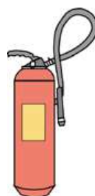
Sl. 55. Aparat pod stalnim tlakom za početno gašenje požara prahom. Dijelovi aparata jesu spremnik, ručica za aktiviranje, osigurač, crijevo i mlaznica te često manometar. Na aparatu se mora nalaziti naljepnica s rokom uporabe. Najmanje jednom godišnje aparat provjerava ovlaštena pravna osoba. Spremnik je pod stalnim tlakom od cca 15 bara.
